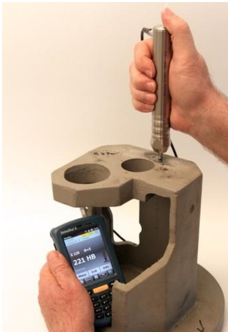
Tester de duritate rapid și precis noul SonoDur 2 pe fontă GGG50 și control de la distanță, prin PC
